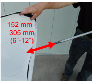
LICHT REINIGEN ALLEEN MET PERSLUCHT, VAN BUITEN NAAR BINNEN. HOUD DE ZUIGMOND OP 15-30 CM VAN DE STOF
