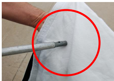
LICHT REINIGEN ALLEEN MET PERSLUCHT, VAN BUITEN NAAR BINNEN. HOUD DE ZUIGMOND OP 15-30 CM VAN DE STOF
